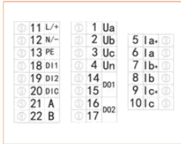
PM-300接线端子台脚位图
