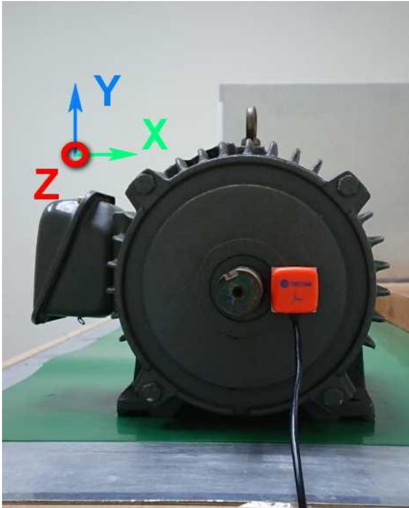
采用轴向安装位置时，图标代表为测得的正确振动轴向
