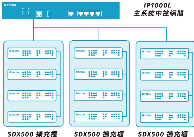
IP1000L 整合SDX500系統堆疊架構設計，提供各種網路介面，搭配多款終端設備，輕鬆滿足企業通訊多樣化需求。
